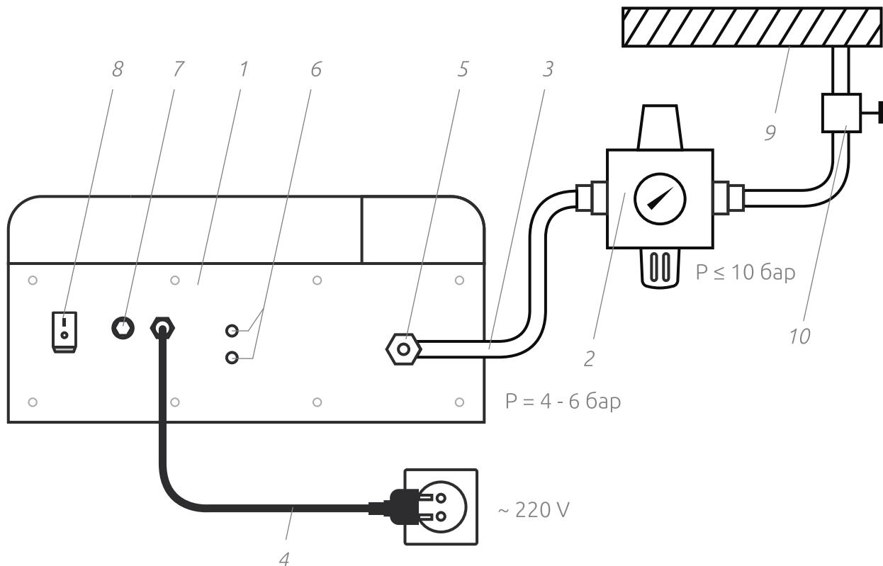
1. Пневмоэлектрическая перемешивающая установка (вид сзади);
